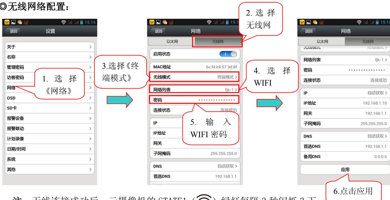
注：无线连接成功后，云摄像机的 STATE1 (📶) 绿灯每隔 3 秒闪烁 3 下。
