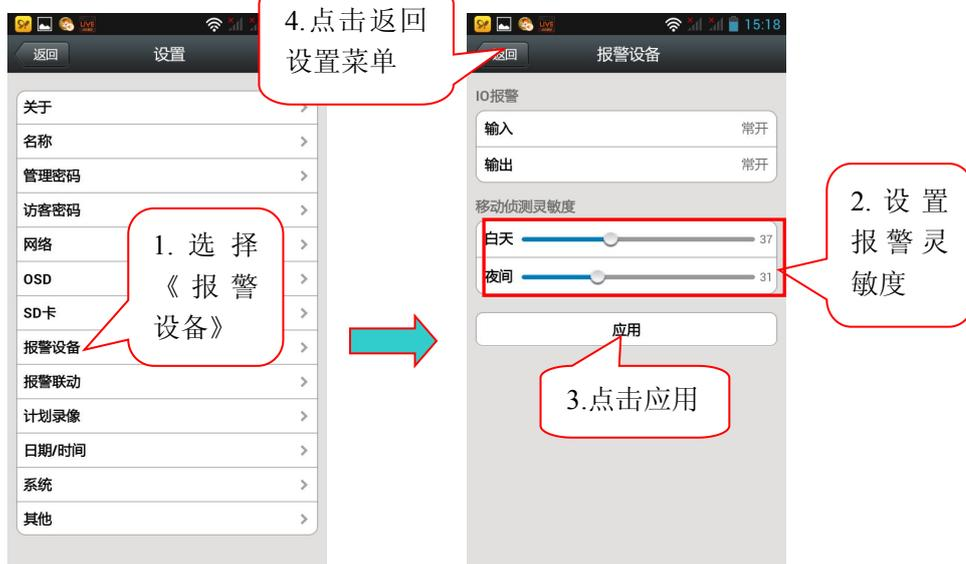
**I/O报警输入：**选择常开时，对应报警输入口连接外部报警探头（如门磁，红外，烟感等报警探头）必需是常开型的报警探头。当有警情发生时，探头开关闭合，触发网络摄像机产生警情，并按照用户设置的功能进行报警；
