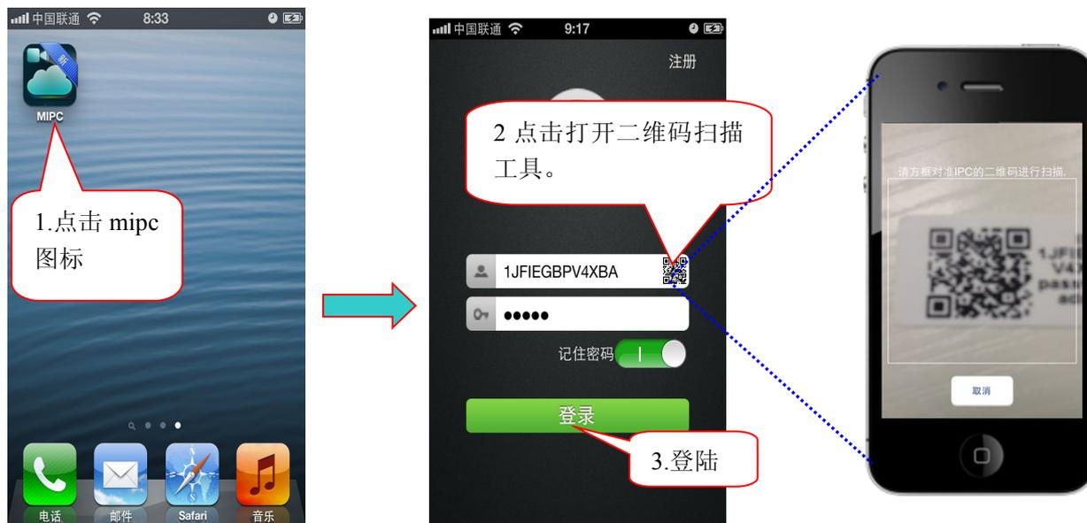
注：如果二维码扫描不到，需要手动输入机器上的 ID 及密码（每台摄像机都配有一个唯一的 ID 号及密码）。
