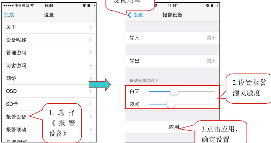
I/O报警输入：选择常开时，对应报警输入口连接外部报警探头（如门磁，红外，烟感等报警探头）必
