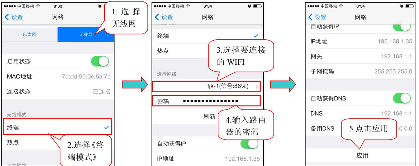
注：连接成功后，云摄像机的 STATE1 (📶) 绿灯每隔 3 秒闪烁 3 下。
